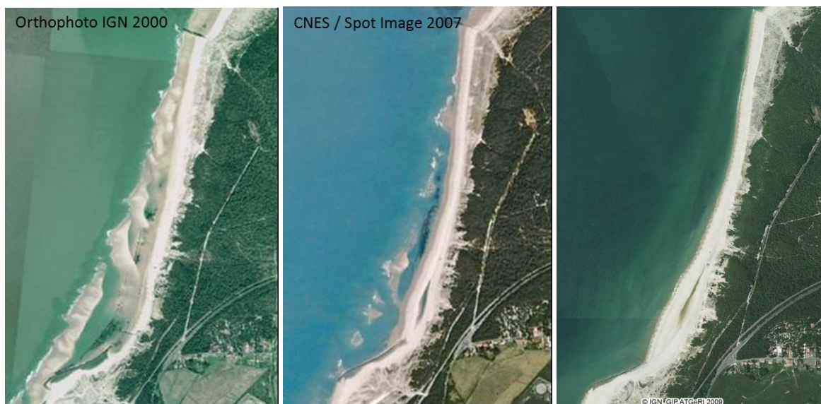
Illustration 104 - By-pass sableux sur le secteur des Cantines, des Huttes aux rochers de Saint-Nicolas (sous-cellule 1.2, commune du Verdon-sur-Mer). L'accolement du banc à la côte est visible en 2007 (et 2009) et entraîne un élargissement temporaire de la plage dans ce secteur, pourtant en érosion chronique.
