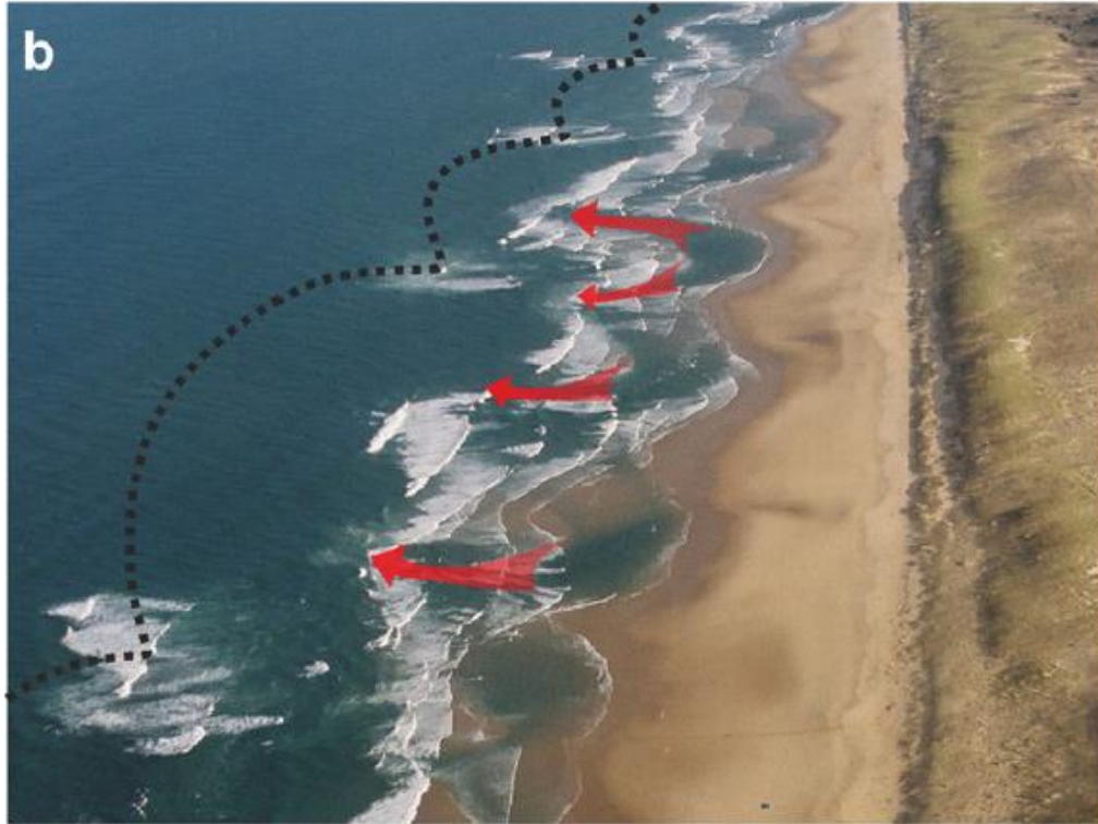
Illustration 46 - Courants de baïnes (flèches rouges) au travers de la barre sableuse interne sur la plage du Truc Vert (Gironde) ; la ligne pointillée souligne la barre externe en croissant (photo : P. Larroudé, Castelle et al., 2016)
