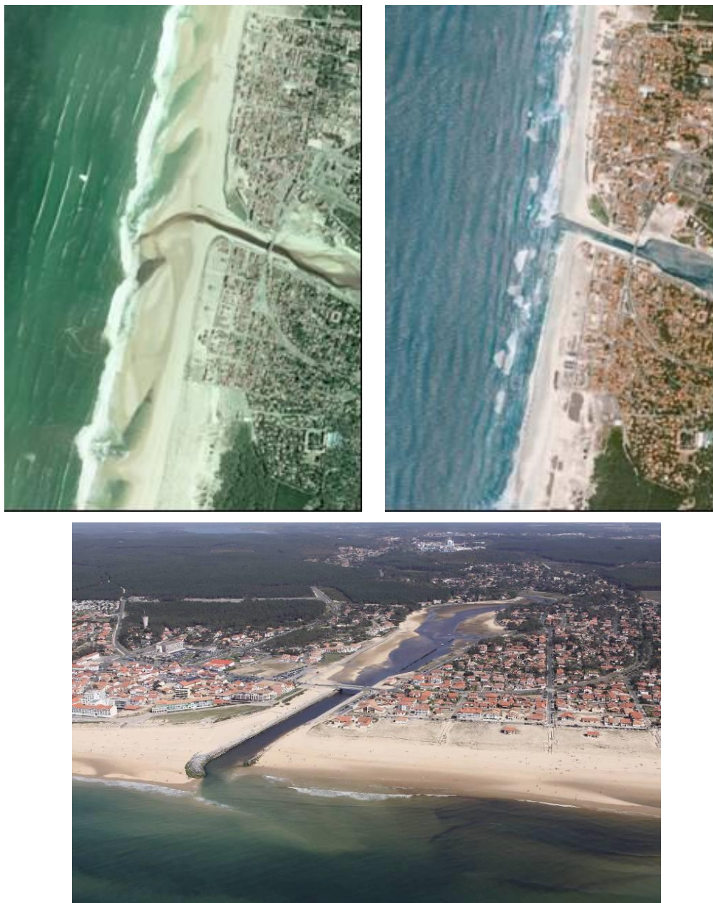
Illustration 189 - Orthophoto IGN de Mimizan-Plage en 2000 (à gauche), image SPOT 2007 (à droite) et photographie aérienne de 2010 (en bas, © Michel Le Collen). Bien que le niveau de marée soit différent, une accentuation du décrochement entre 2000 et 2007 avec un estran beaucoup plus restreint au sud du courant est visible.
