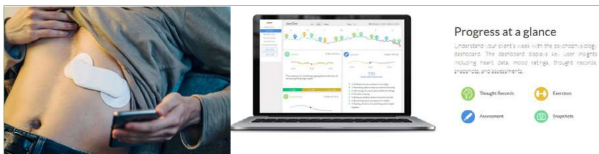
Figure 14 : Le capteur de Lief Therapeutics autorise le monitoring continu du rythme respiratoire et de la fréquence cardiaque afin d'établir un marqueur de stress
